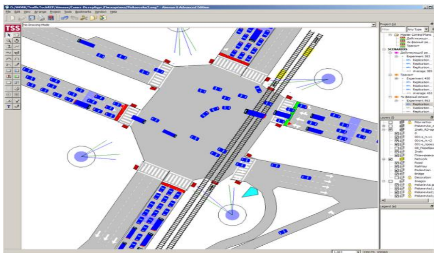
Рис. 3. Реализация интерфейса для микро-моделирования Aimsun
